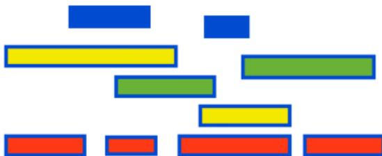
**Greedy Idee.** Finde maximale Anzahl von Intervallen für **eine Maschine** (= Interval Scheduling, Greedy optimal). → **nicht optimal**
