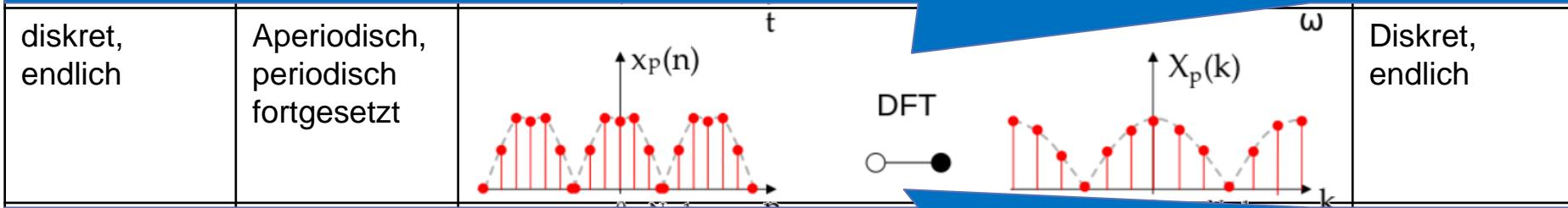
Es entsteht ein diskretes Frequenzspektrum mit Spiegelspektren. Die DFT und deren Optimierungen in Form der **schnellen Fourier-Transformation (FFT)** spielen in der digitalen Signalverarbeitung eine bedeutende Rolle.
